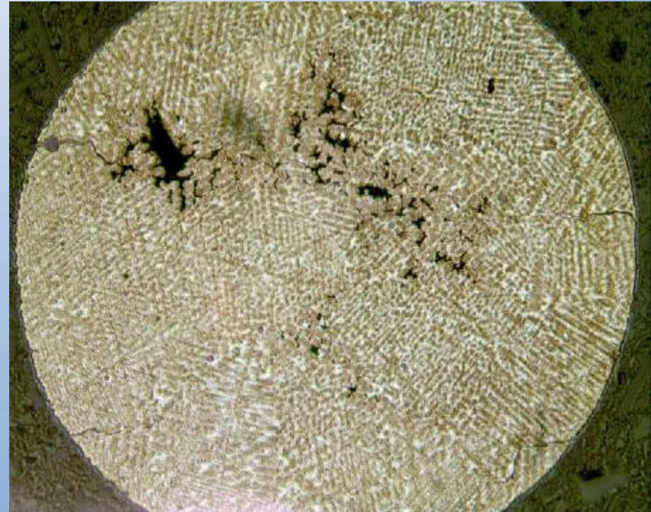
zvětšeno 100x : jemné broušení, jehličkovitě-martensitická mikrostruktura, ukazující dutiny a inkluze strusky
