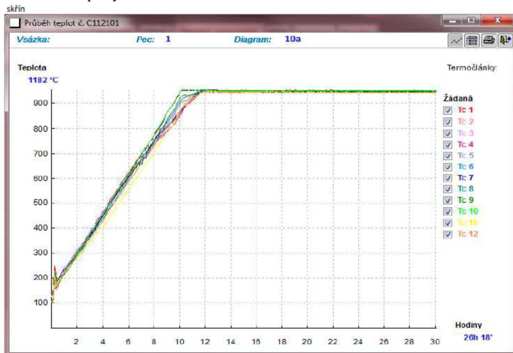
b) Obr. 8.2: Náběh teploty u odlitku skřín
