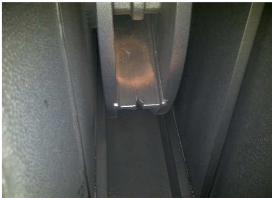
Kromě tohoto jevu byl zjištěn průnik abraziva uzavřenou dávkovací jednotkou a údajnou netěsností ventilu na bunkru abraziva – nebezpečí zasypaní korečkového dopravníku.
