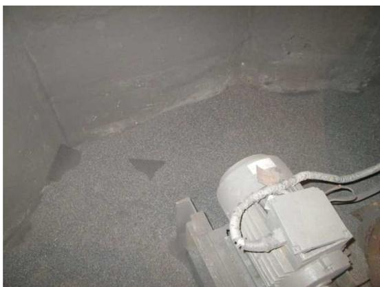
**Obr. 7.13: Chybějící část rotačního síta**
