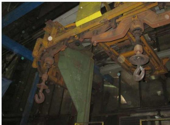
**Obr. 7.16: Nově instalovaná drážka pro pohyb odlitků z Čistírny na průběžný tryskač Carlo Banfi, nosnost 5t**
