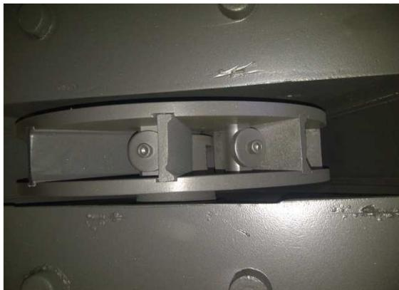
U takto nastaveného usměrňovače (viditelné okno) je zřejmé, že paprsek abraziva směřuje do tělesa turbíny. Nutno zkontrolovat nastavení dle dokumentace výrobce.
