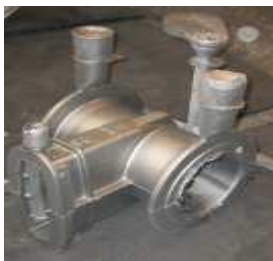
Obr. 31 Odlitek s nálitky z ruční formovny
