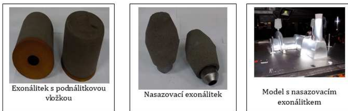
Obr. 30 Příklady exotermických nálitků a modelů s exonáliekem
