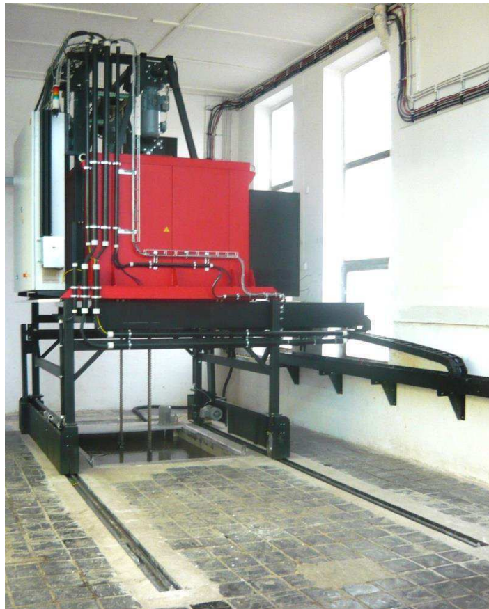
Obr. 7.2: Energeticky výhodná pec se spouštěním vsázky do vodní lázně dnem
